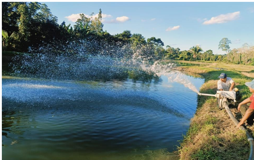
Figura 1. Oxigenación de estanque con motobomba. Villa Tunaris, Cochabamba, Bolivia
